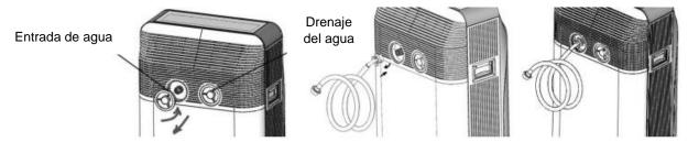
Una vez conectada la manguera de agua al aire acondicionado, existen 5 formas de conectar la manguera de agua al grifo. Hay que tener cuidado de que la conexión sea estanca. Los 3 conectores de manguera diferentes están diseñados para diferentes grifos.
